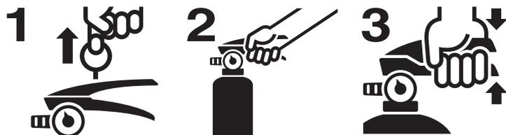
1 安全栓を引き抜く      2 ノズルを火元に向ける      3 レバーを強くにぎる
